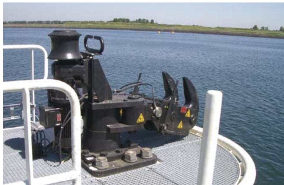
Schnell-Entkopplung: in Notsituationen können diese Schlepphaken die Trosse in Sekundenschnelle freigeben
