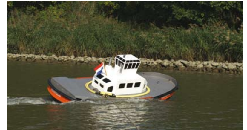
Neues Schleppsystem: der Schlepphaken ist frei um das Ruderhaus beweglich
